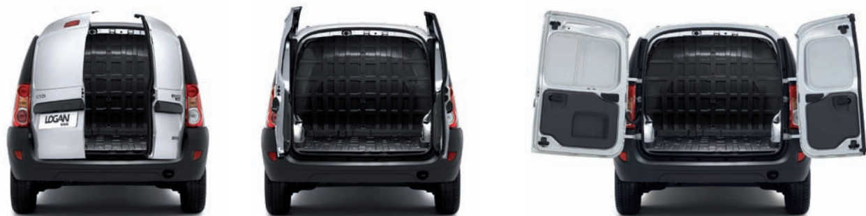
Ángulos de apertura de las puertas traseras (40°, 90° y 180°) y mampara completa.
